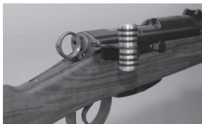
Bild 25: Riegelgriff anatomisch zu Karabiner und Langgewehr
