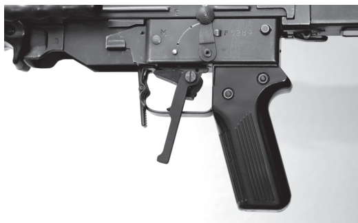
Bild 19: Winterabzug für Linksschützen zu Stgw 57
