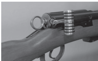
Bild 25: Riegelgriff anatomisch zu Karabiner und Langgewehr
