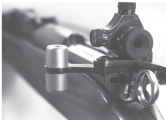
Bild 23: Linksriegel zu Karabiner 31
